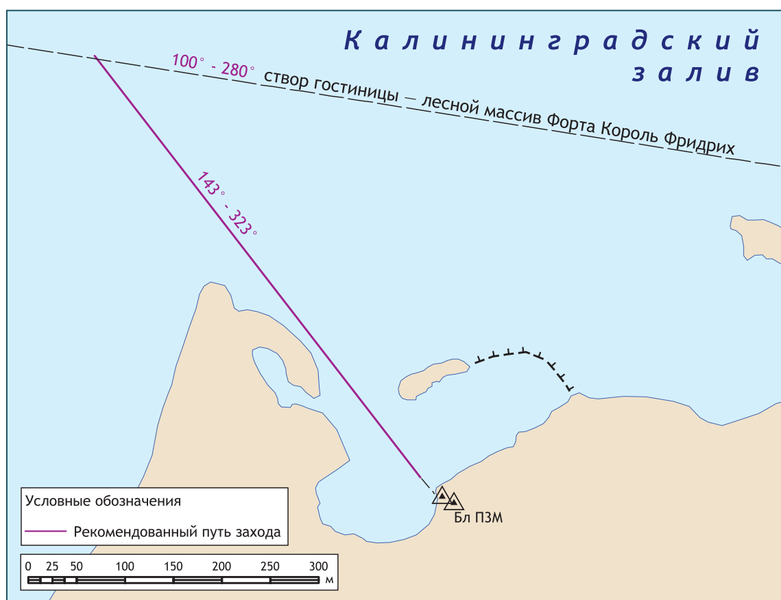
Рис. 13.3. Навигационные особенности захода в гавань яхт-клуба [Источник: схема подготовлена в рамках проекта VILA]
