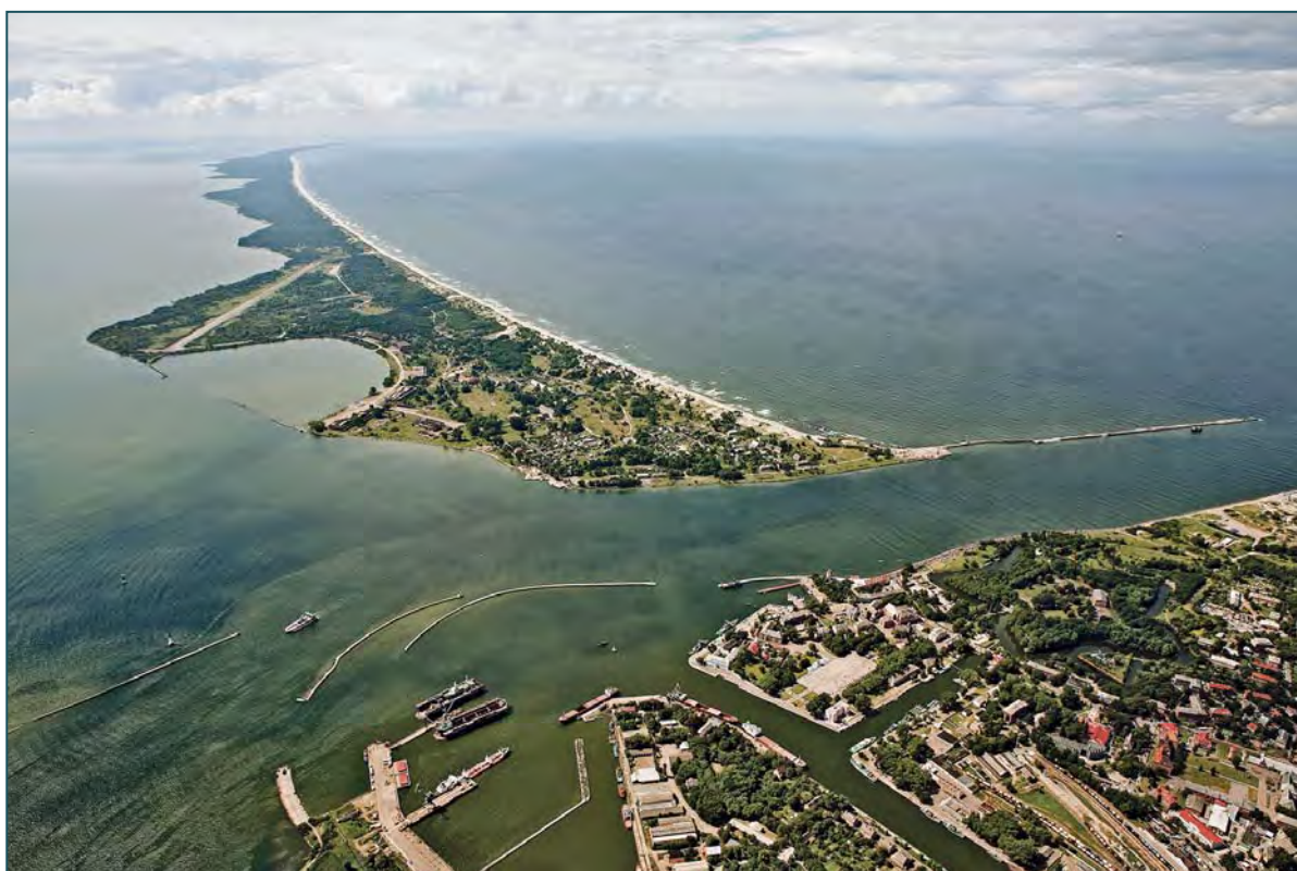
Рис. 1.4. Соединение Калининградского/Вислинского залива с Балтийским морем в районе г. Балтийск. Вид с северо-востока на уходящую в сторону Польши Балтийскую/Вислинскую косу (слева – залив, справа – море), поселок Коса и Гидроавиационную гавань (на косе), и портовые акватории Балтийского грузового района, прикрытые со стороны залива двумя дуговыми молами [Источник: Архив Морского института в Гданьске]
