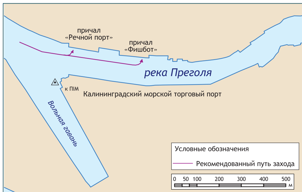
Рис. 15.3. Навигационные особенности захода к причалу «Фишбот» [Источник: схема подготовлена в рамках проекта VILA]
