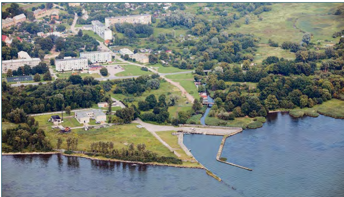
Рис. 18.1. Гавань Приморск (канал в русле реки Приморская, прикрытый бетонными причальными сооружениями, образующими треугольную бухту), вид с юга [Источник: Архив Морского института в Гданьске]
